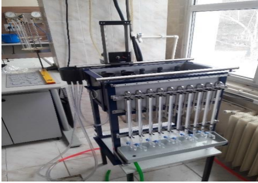
Şekil 3.6. ICW laboratuvar permeametrosiyle hidrolik iletkenlik ölçümleri
