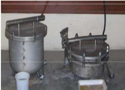
Şekil 3.5. Basınçlı membran aletinde tarla kapasitesi ve solma noktasında tutulan nemin belirlenmesi
