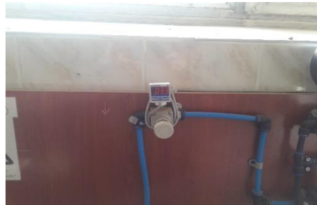
Şekil 3.5. Basınçlı membran aletinde tarla kapasitesi ve solma noktasında tutulan nemin belirlenmesi
