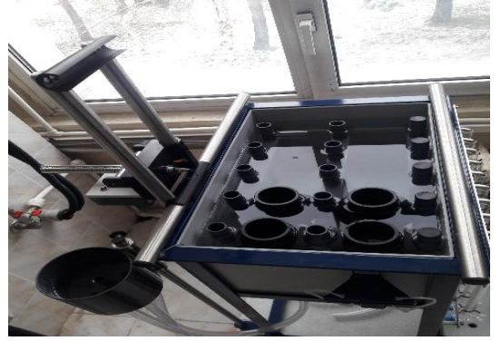
Şekil 3.6. ICW laboratuvar permeametrosiyle hidrolik iletkenlik ölçümleri
