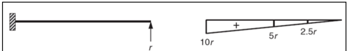
Şekil 3.6. Sistemin yalnız r etkisindeki moment diyagramı
