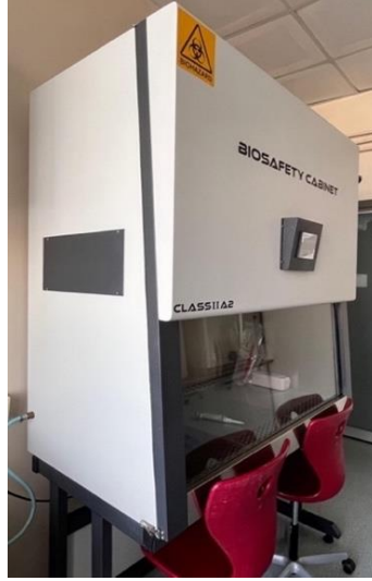
Şekil 3.14. Class II biyogüvenlik kabini
