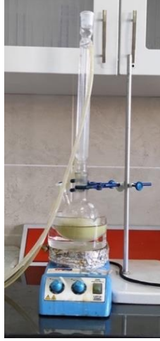
Şekil 3.4. Bitki ekstresi hazırlamak için kullanılan reflüks sistemi
