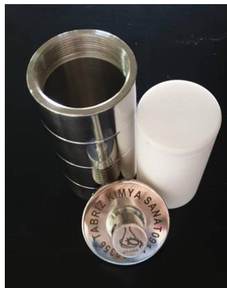
Şekil 3.6. Hidrotermal reaktör ısıtıcı ve çelik ünite
