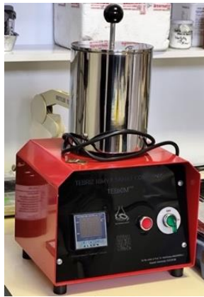
Şekil 3.6. Hidrotermal reaktör ısıtıcı ve çelik ünite
