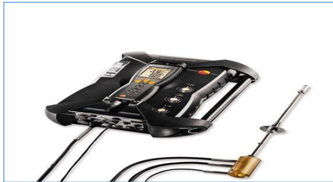
Şekil 18. Testo 350 egzoz emisyon ölçüm cihazı
