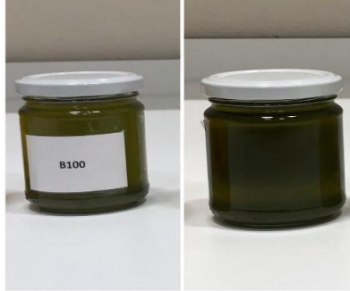
Şekil 11. Transesterifikasyon sonucu üretilen biyodizel (B100)
