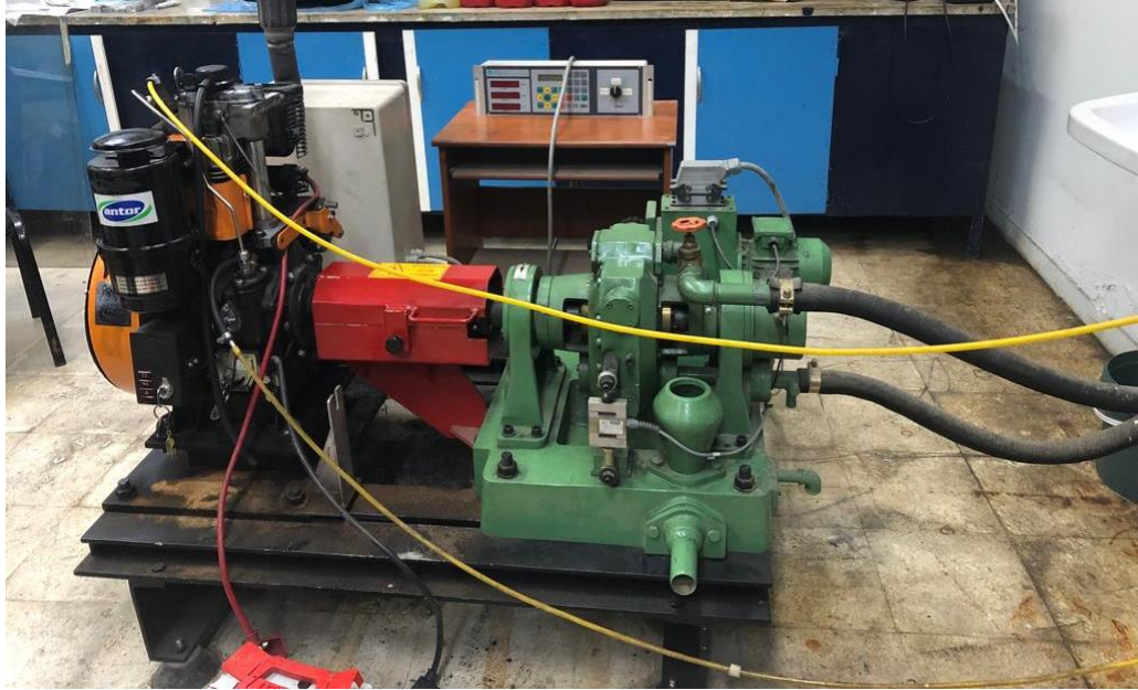
Şekil 16. Sıkıştırma ile ateşlemeli test motoru ve dinamometresi
