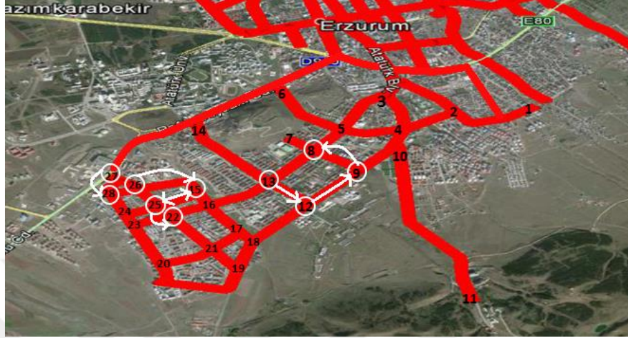
Şekil 4.9. 7. aracın Palandöken ilçesindeki tuzlama yaptığı yollar
