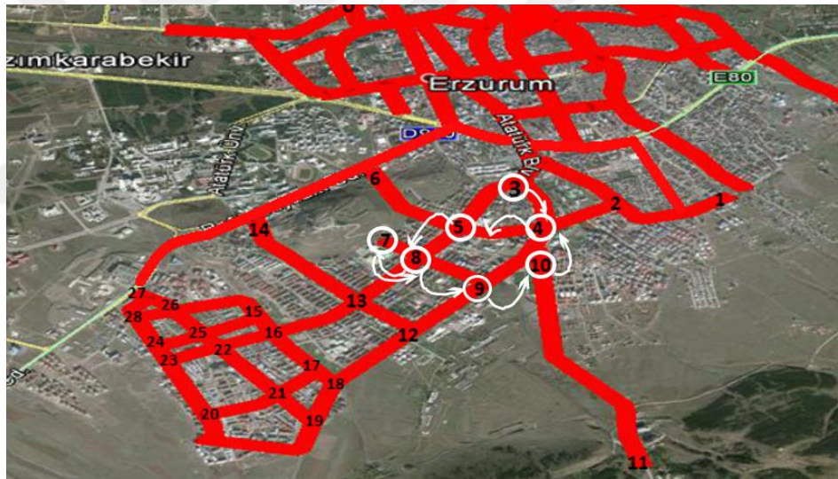
Şekil 4.38. 4. aracın Palandöken ilçesindeki tuzlama yaptığı yollar
