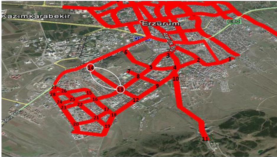
Şekil 4.45. 11. aracın Palandöken ilçesindeki tuzlama yaptığı yollar
