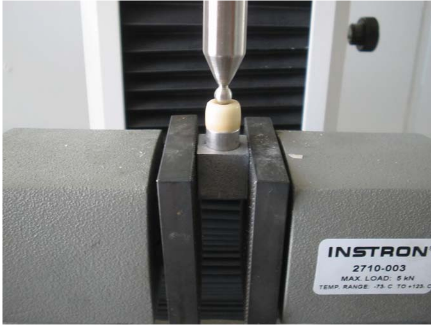
Şekil 3.13: Instron Universal Test Cihazında kırılma direnci testi
