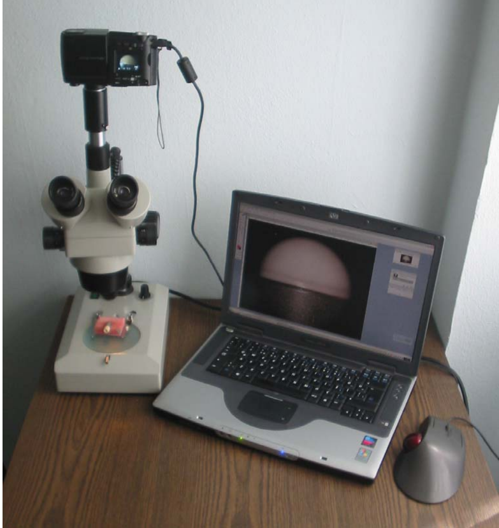
Şekil 3.10-a: Marjinal uyum ölçümlerinin yapıldığı sistem.
