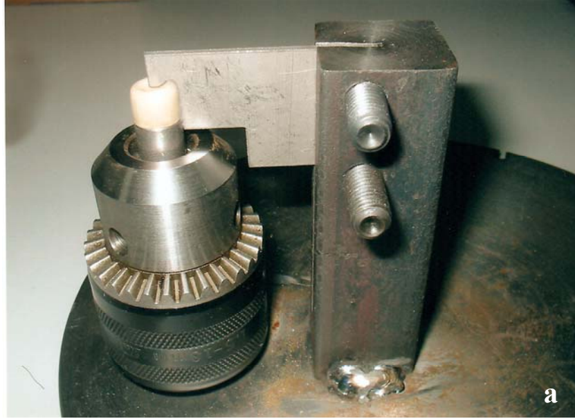
Şekil 3.2-a: Standardizasyon cihazı (sculpturing device)
