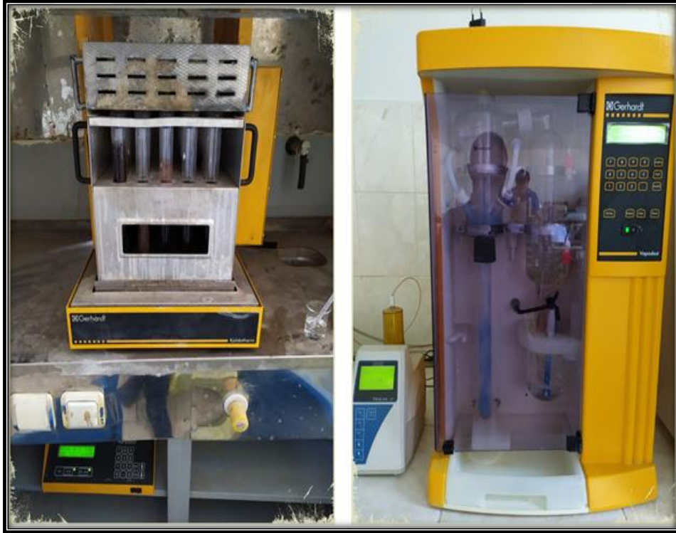
Şekil 3. Örneklerde azot tayini için yaş yakma, destilasyon ve titrasyon işlemleri
