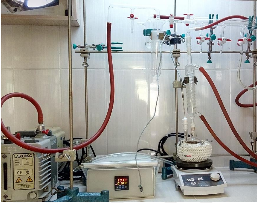
Şekil 3.1. Oleyilamin kaplı \text{Fe}_3\text{O}_4 MNP sentezi için kullanılmış olan schlenk sistemi
