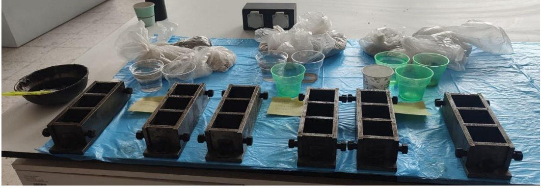
Şekil 49. Beton üretimi hazırlık aşaması (Malzemelerin tartılması ve çelik kalıpların yağlanması)
