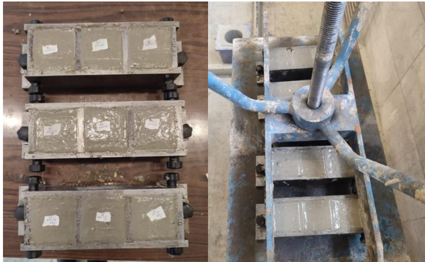
Şekil 50. Kalıba yerleştirilen taze beton ve sarsma tablasıyla sıkıştırma işlemi
