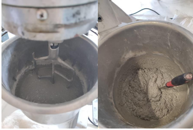
Şekil 48. Taze beton üretim aşaması
