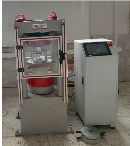
Şekil 38. Beton basınç dayanımı deney presi
