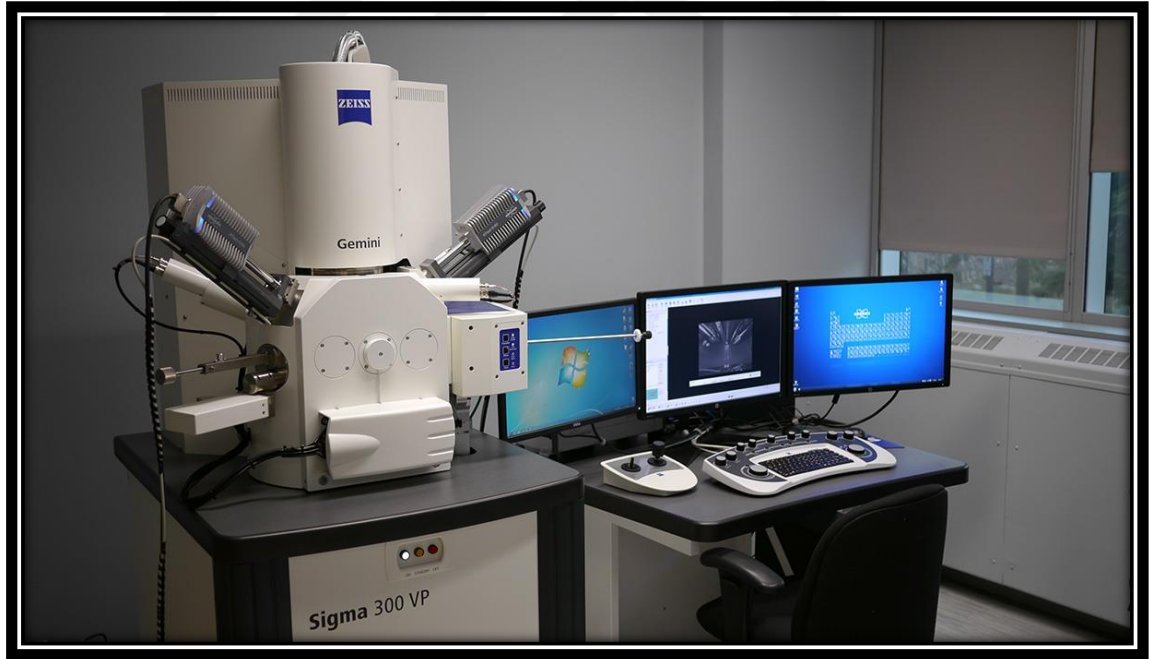
Şekil 3.2. Atatürk Üniversitesi Doğu Anadolu Yüksek Teknoloji Uygulama ve Araştırma Merkezinde bulunan Zeiss Sigma Family Taramalı Elektron Mikroskobu (SEM)
