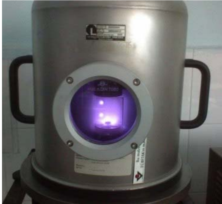
Şekil 3.4. Plazma nitrürasyon işlemi uygulama görüntüsü
