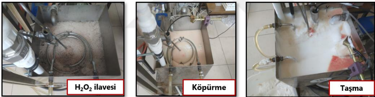
Şekil 54. HK/H 2 O 2 oksidasyonunda aşırı köpürme ve taşma (0,22 C v , 7 bar, 30°C, pH 4,0, 2500 mg/L, H 2 O 2 )
