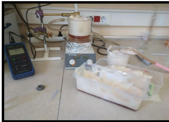
Şekil 45. H_2O_2 oksidasyonunda yüksek H_2O_2 konsantrasyonun meydana gelen aşırı köpürme (Doğal pH)
