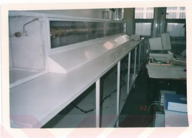
Şekil 5.15. İki fazlı akış test bölümünün yandan görünüşü
