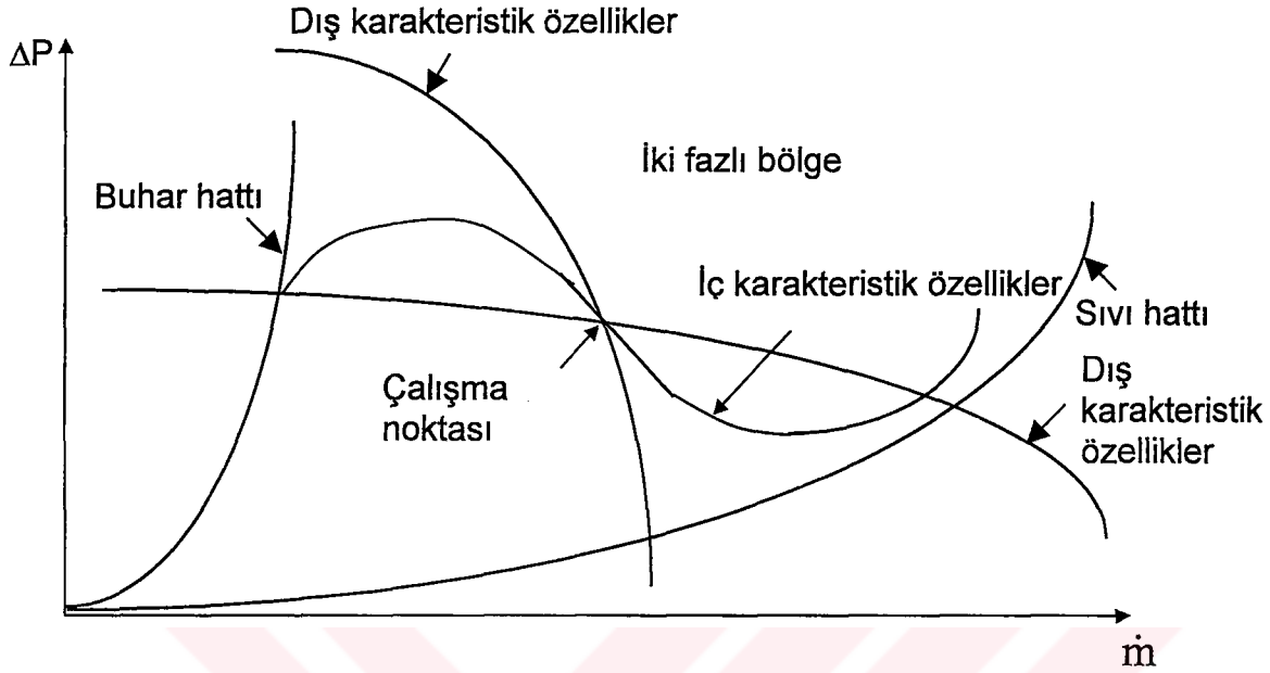
Şekil 2.2. Tipik bir iki fazlı akış sisteminin karakteristik özellikleri
