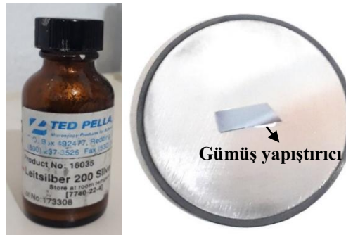
Şekil 3.6. a) Gümüş yapıştırıcı b) Yapıştırılan silikon alttaş
