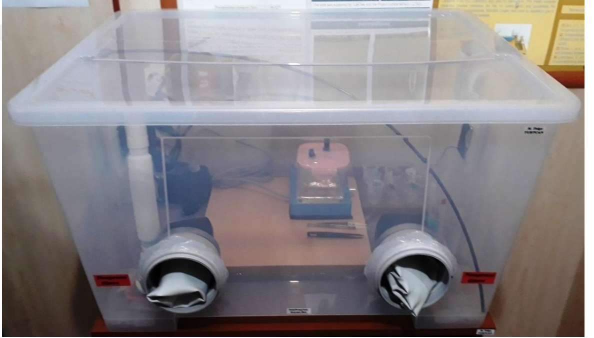
Şekil 3.4. Silikon temizleme işlemi için kullanılan glovebox
