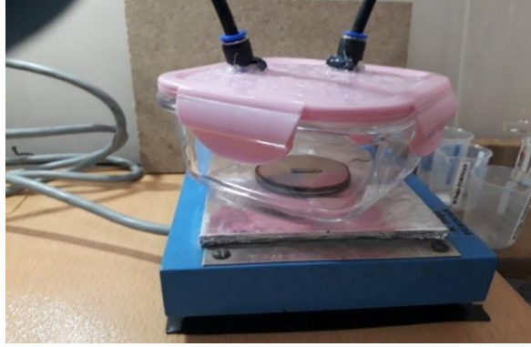
Şekil 3.7. Silikon alttaşın oksitlenmesini engellemek için yapılan düzenek
