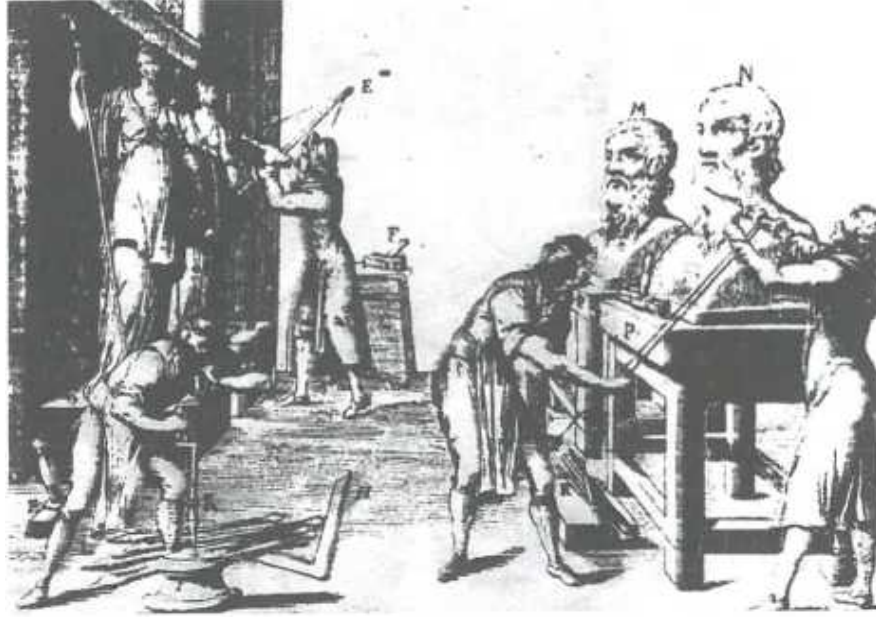
Resim 2.27. XIX. Yüzyıl Heykel Atölyesinde Kullanılan Kopyalama Yöntemleri
