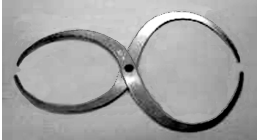
Resim 2.17. Sadece 1 / 2 Büyütme Ya Da Küçültme Yapabilen Sabit Oranlı Pergel 57
