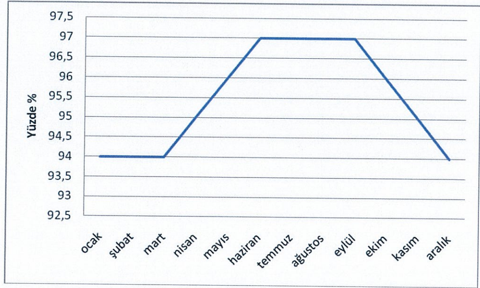
Şekil 4.39. Kojenerasyon elektrik ihtiyacı karşılama
