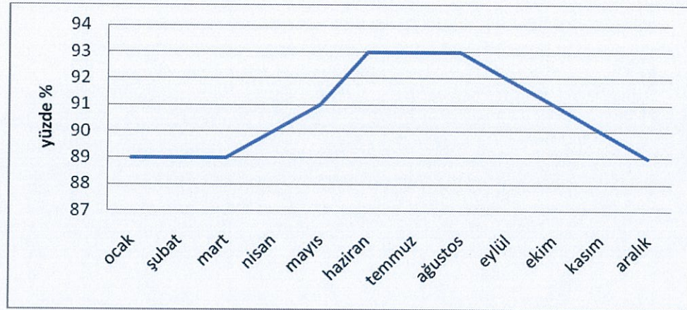
Şekil 4.47. Kojenerasyon elektrik ihtiyacı karşılama
