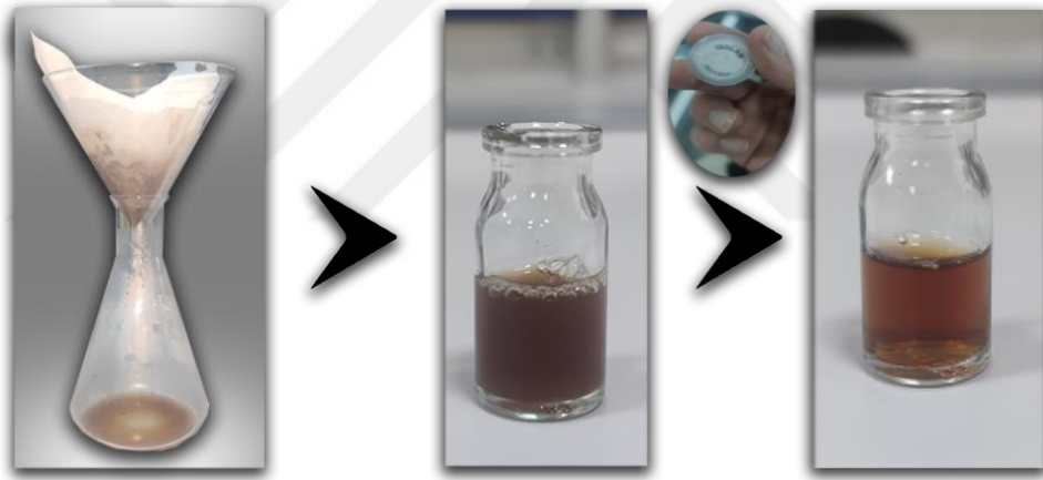
Şekil 22. Sulu süspansiyonun süzülme aşamaları
