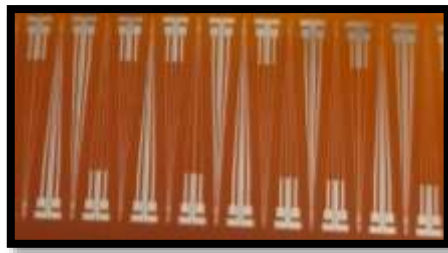
řekil 3.11. Lift-off iřlemi sonrası mikroelettrot serileri
