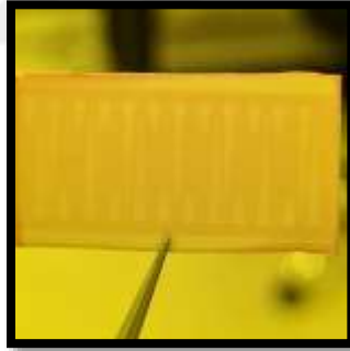
Şekil 3.9. Banyo sonrası alttaş üzeri desen görünümü
