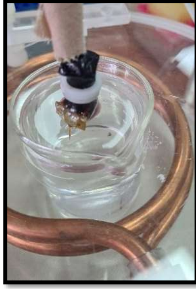
Şekil 3.13. Hareketli hayvan mikroeletrodu kalibrasyonu
