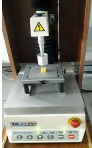
Şekil 8. Lokum örneklerinde yapılan tekstür profil analizi
