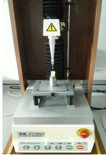
Şekil 12. Lokum örneklerinde yapılan delme testi
