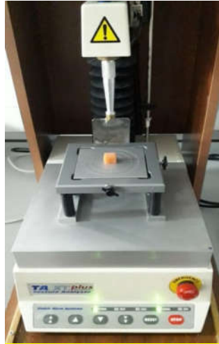
Şekil 10. Lokum örneklerinde yapılan kesme testi
