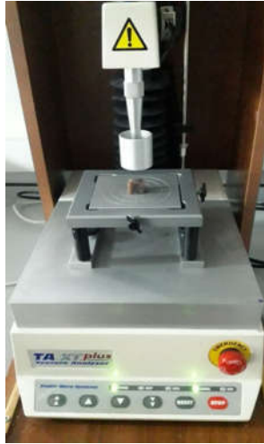
Şekil 14. Lokum örneklerinde yapılan gerilim gevşeme testi
