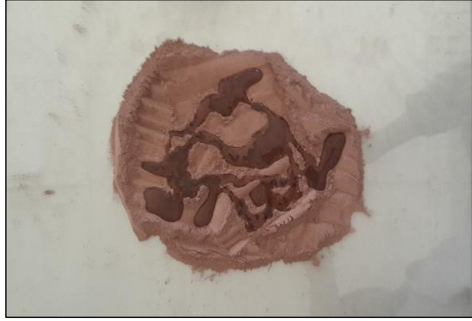
Şekil 3.11. Kil-ponza karışımının çözünmüş KBG ile karıştırılması
