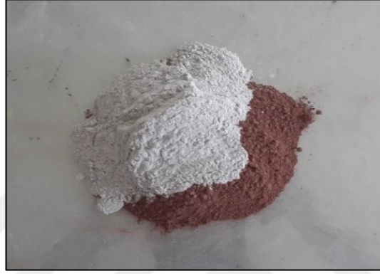
Şekil 3.8. Kil ile ponzanın kuru halde karıştırılması
