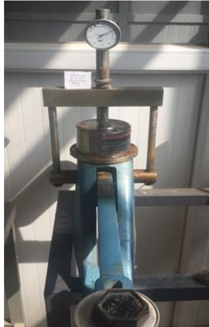
Şekil 3.18. Ödometre deney aletinde şişme basıncı deneyinin yapılışı
