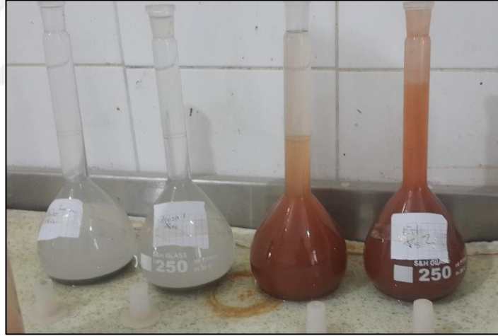
Şekil 3.10. Kil ve ponzanın özgül ağırlıklarının belirlenmesi
