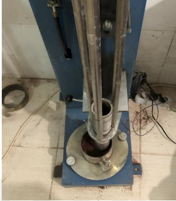
Şekil 3.13. Otomatik kompaktör ile kompaksiyon deneyinin yapılışı
