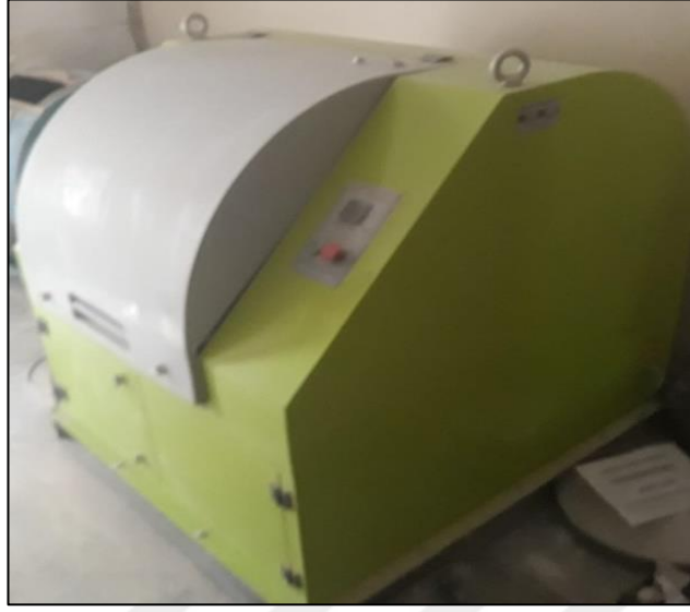
Şekil 3.2. Los Angeles aşındırma cihazı
