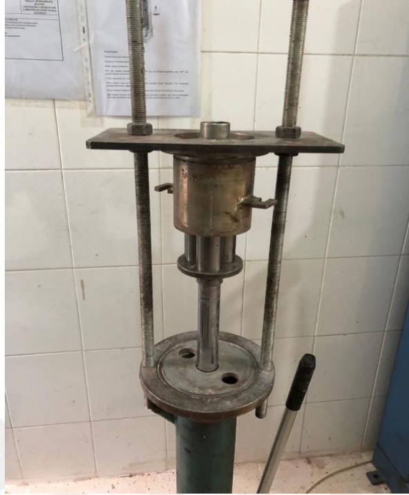
Şekil 3.14. Manuel hidrolik numune ıkarma krikosu ile serbest basın numunesinin alınışı
