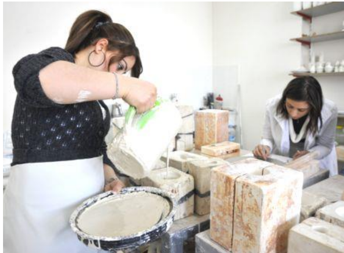
Fotoğraf 38. Alçı kalıp döküm işlemi
