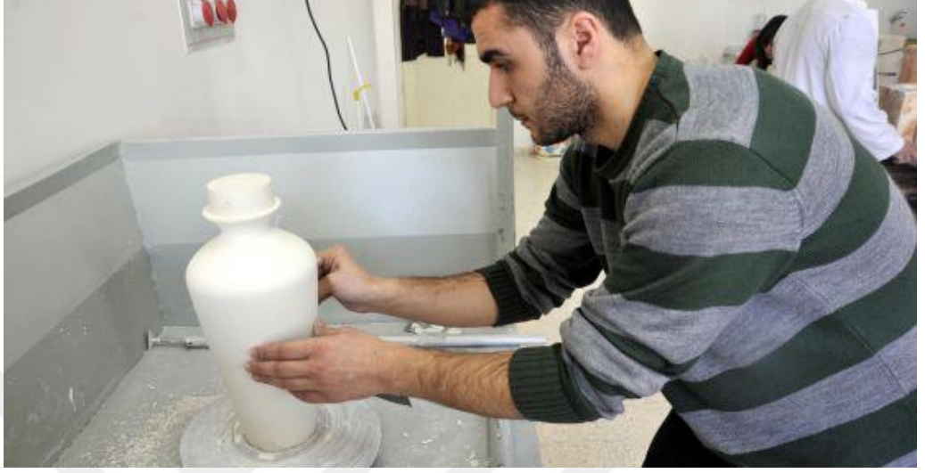
Fotoğraf 39. Alçı kalıp oluşturma işlemi
