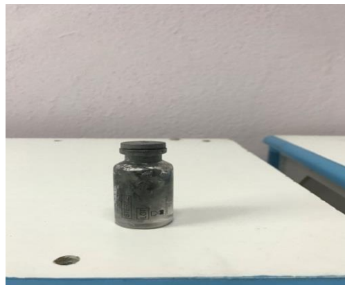
Şekil 103. % 10 PVA + 5 ml Triton X-100 + 0,1 g SiC jel fantom numunesi
