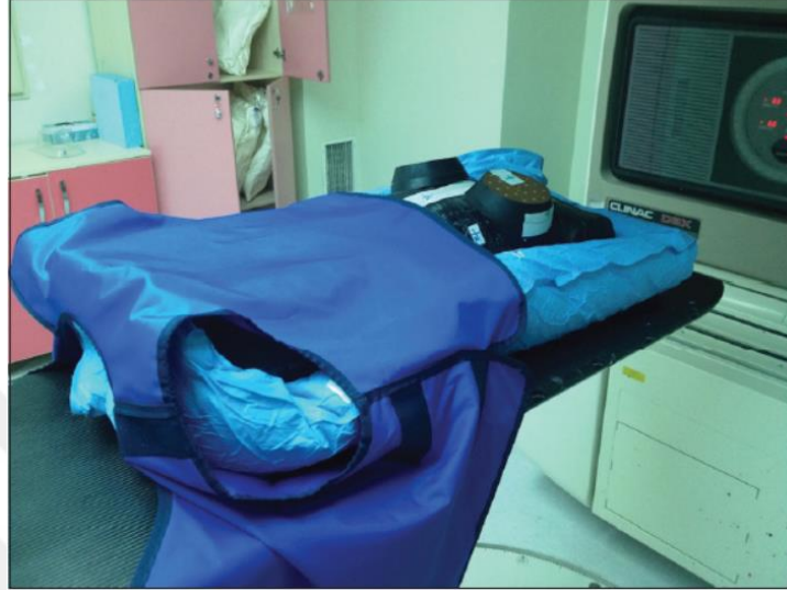
Şekil 12. Kurşun önlüğün fantom üzerine yerleştirilmesi. Önlük, simüle edilmiş hamile hastanın rahatlığını sağlamak için fantomun karın bölgesini gevşek bir şekilde kaplamıştır (Öğretici et al. 2017).
