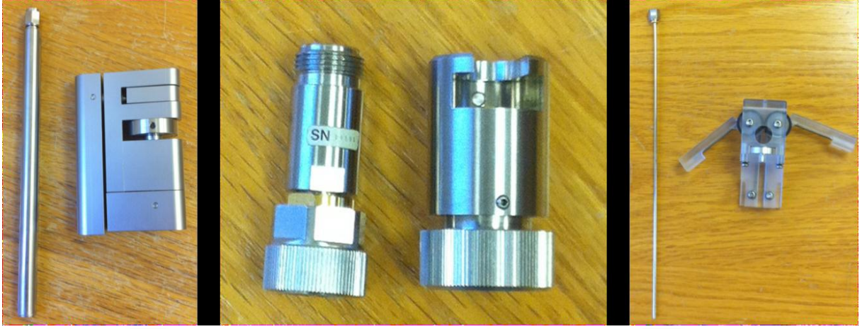
Şekil 45. (a) Performans Probu, (b) Yüksek Sıcaklık Probu ve (c) İnce Prob (Dancsisin 2011)
