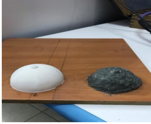
Şekil 104. % 10 PVA + 5 ml Triton X-100 + 0,1 g SiC jel fantom numunesinin kalıptan çıkarılmış görüntüsü
