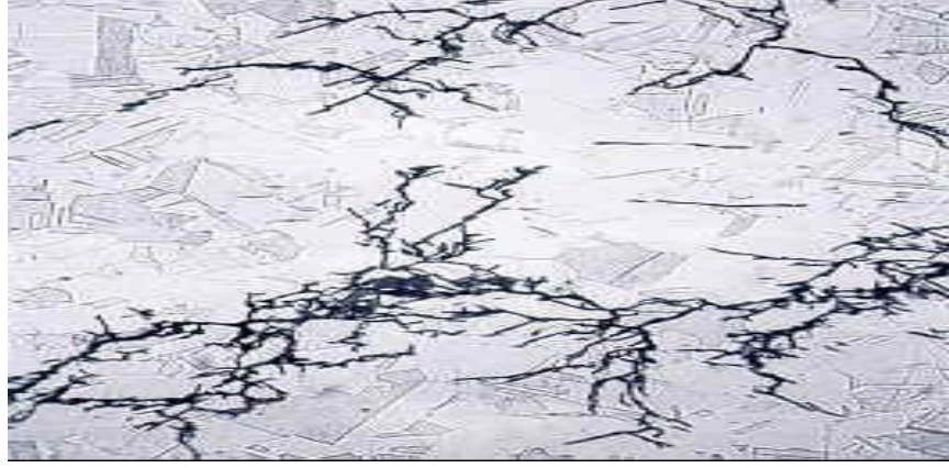
Şekil 1.6. Tipik bir gerilmeli korozyon çatlağı (Mermer 2009)
