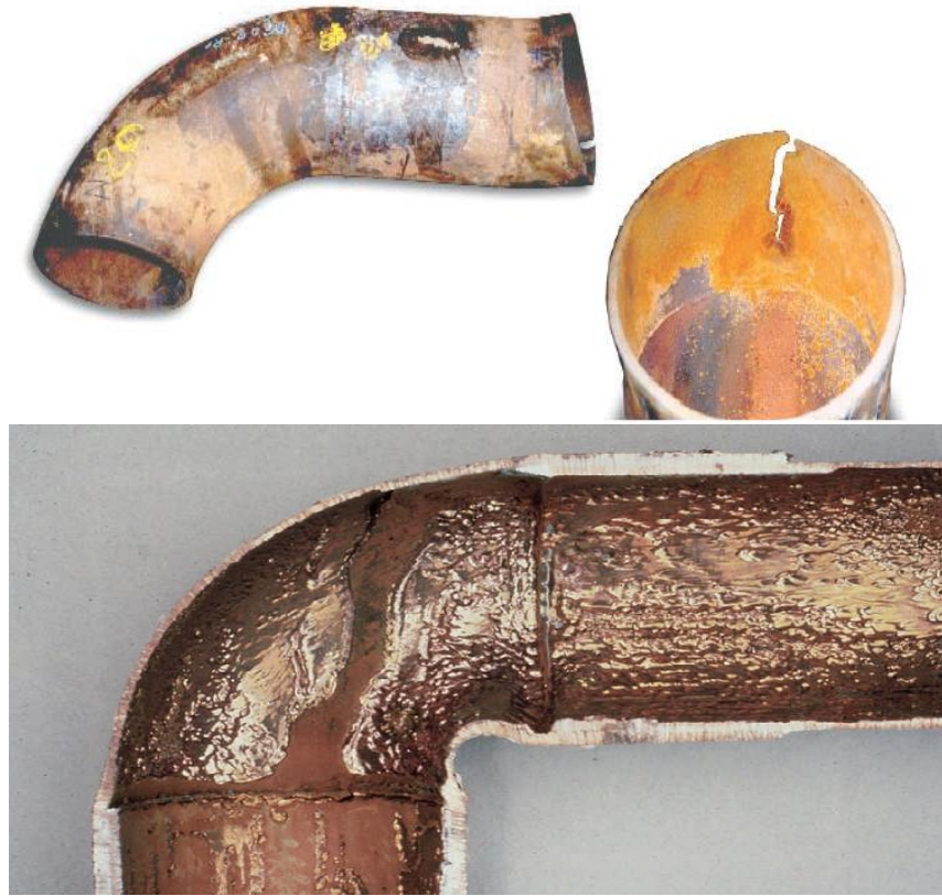
Şekil 1.9. Erozyon korozyonuna uğramış parça resimleri (Aksoy vd 2010)
