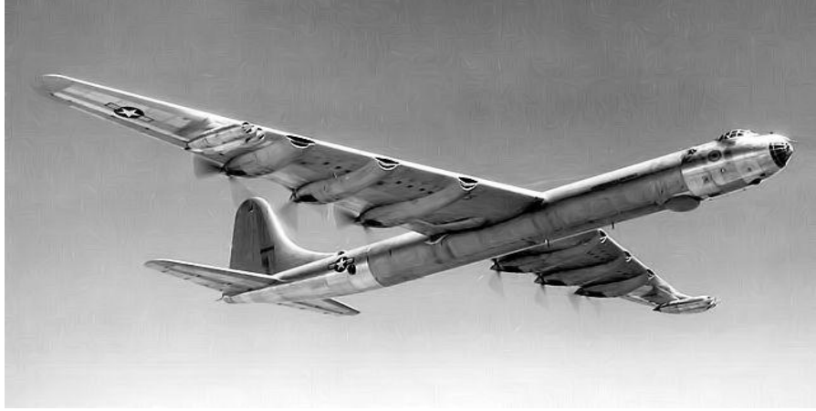
Şekil 2.1. Yapımında toplam 8.600kg magnezyum kullanılan Convair B-36 uzun menzilli bombardıman uçağı (Ostrovsky and Henn 2007)
