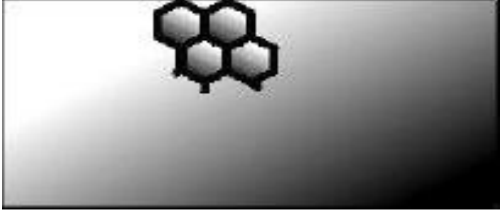
Şekil 1.7. Taneler arası korozyonun şematik görünümü (Mermer 2009)
