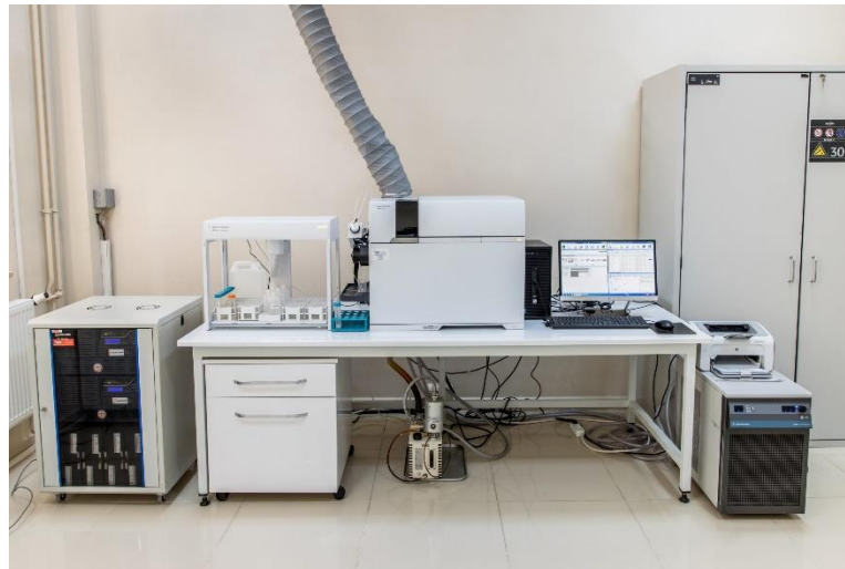
Şekil 27. ICP-MS Cihaz Görseli
