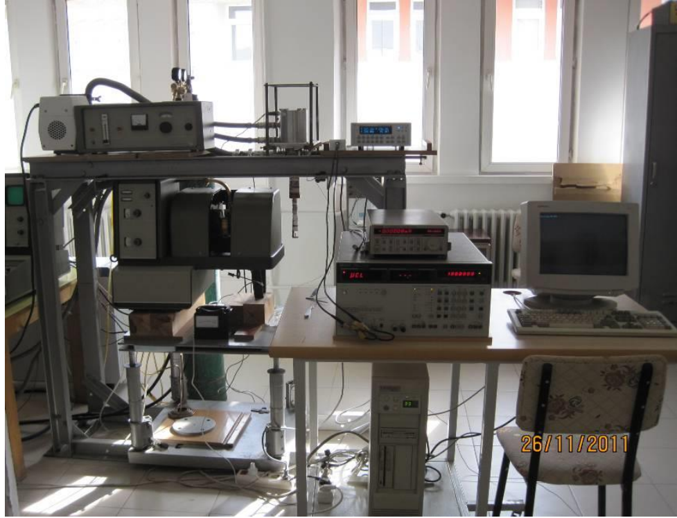
Şekil 3.5. Numunelerin I-V ve C-V karakterizasyonunda kullanılan bilgisayar kontrolünde çalışan KEITLEY 487 Picoammeter/Voltage Source, HP 4192A LF Impedance Analyzer ve Lake Shore 331 sıcaklık kontrol ünitesi ile kontrol edilen ARS HC-2 kapalı devre Helyum (He) kryostatı
