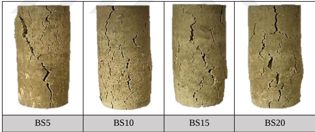
Şekil 4.30. Yedi gün kürde bekletilen stiren akrilik katkılı bentonit kilinin donma çözülme sonrası kırılma şekilleri
