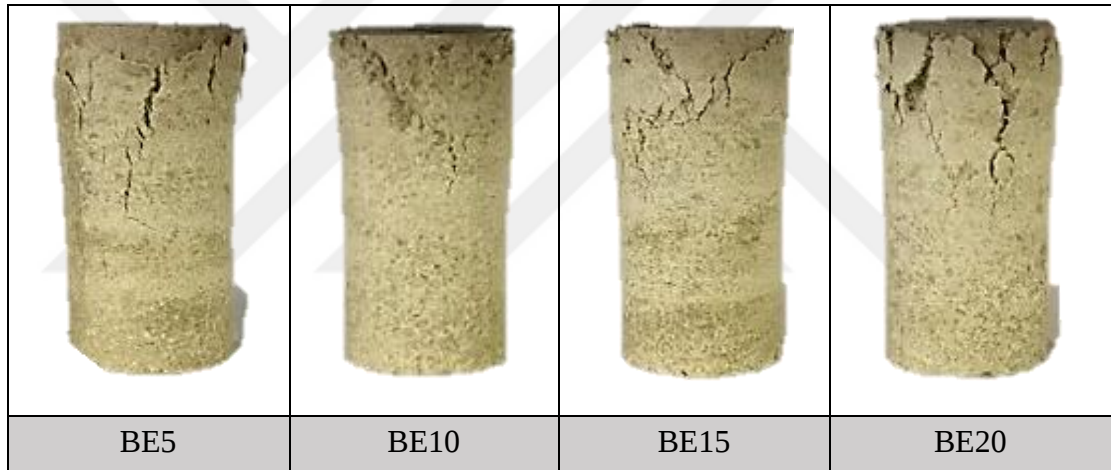
Şekil 4.9. Yedi gün kürde bekletilen epoksi reçine katkılı bentonit kilinin kırılma şekilleri
