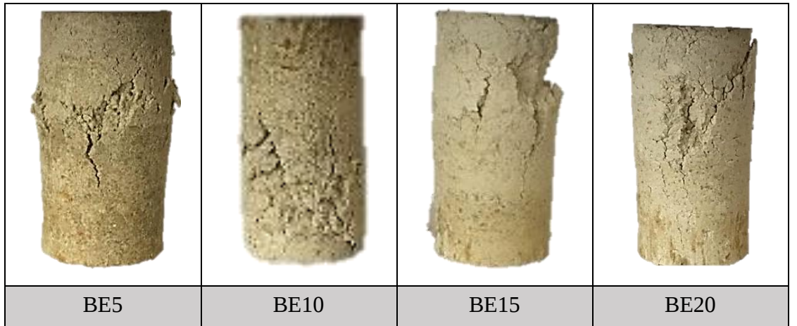
Şekil 4.25. Yedi gün kürde bekletilen epoksi reçine katkılı bentonit kilinin donma çözülme sonrası kırılma şekilleri
