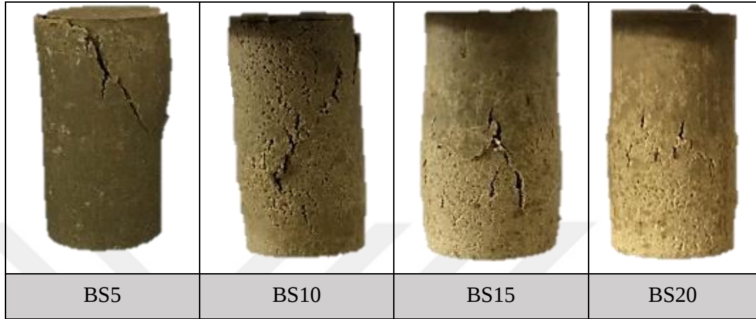
Şekil 4.29. Bir gün kürde bekletilen stiren akrilik katkılı bentonit kilinin donma çözülme sonrası kırılma şekilleri
