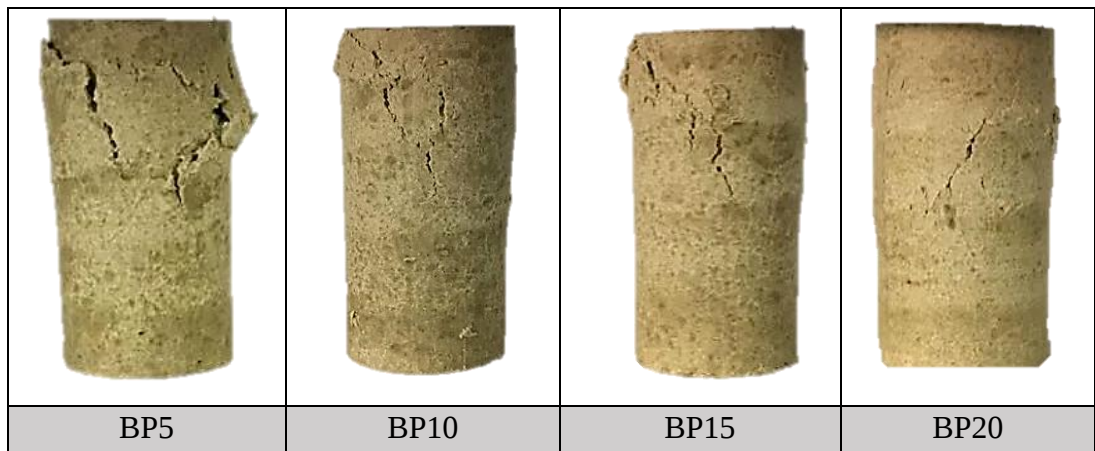
Şekil 4.4. Yedi gün kürde bekletilen poliüretan katkılı bentonit kilinin kırılma şekilleri
