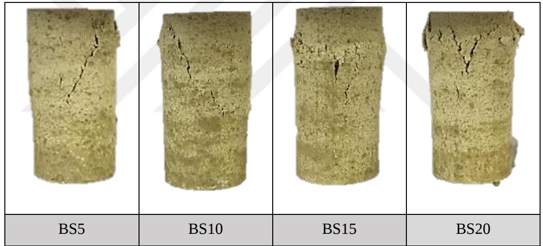
Şekil 4.14. Yedi gün kürde bekletilen stiren akrilik katkılı bentonit kilinin kırılma şekilleri
