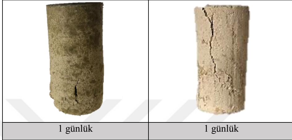
Şekil 4.2. Bentonit ve kaolin kilinin kırılma şekilleri
