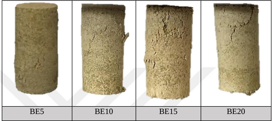
Şekil 4.24. Bir gün kürde bekletilen epoksi reçine katkılı bentonit kilinin donma çözülme sonrası kırılma şekilleri
