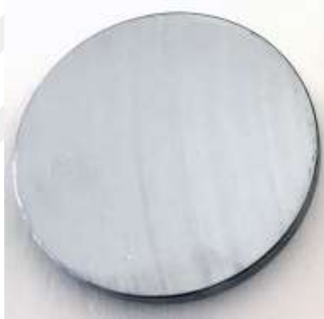
Şekil 10. 4140 Islah Çeliği Disk malzeme
