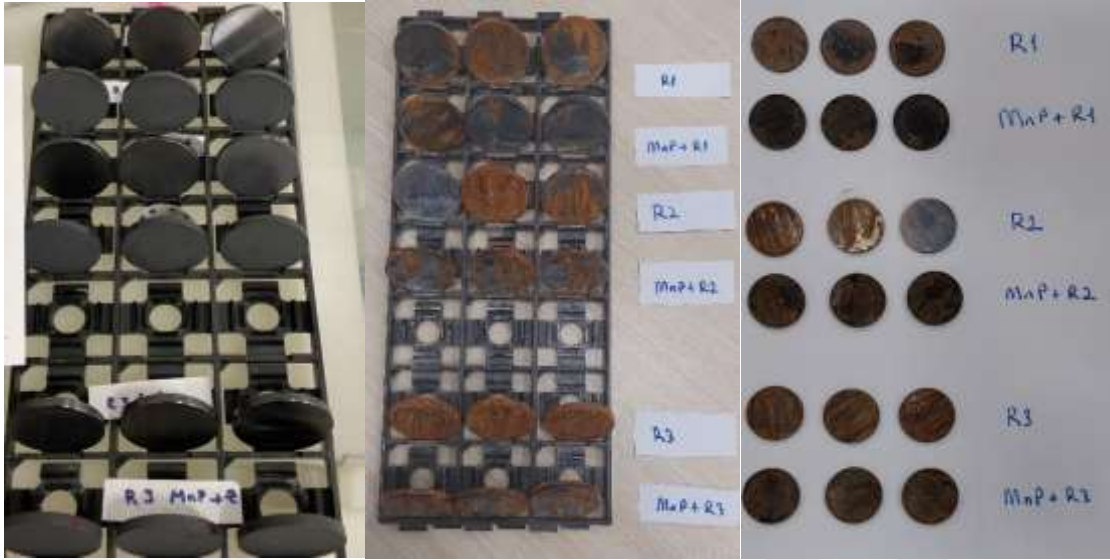
Şekil 94. TiBN:La-hBN Kaplamaların Tuz Sisi Korozyon Dayanım Doğrulama Testi
