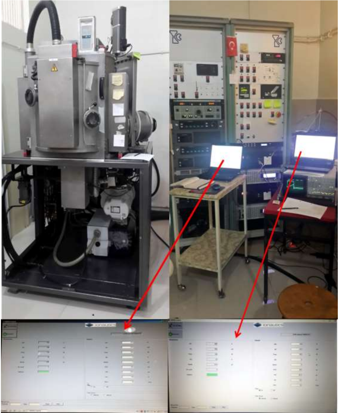
Şekil 14. CFUBM sistemi ve entegre edilen HiPIMS güç kaynaklarının tüm sistem elemanları ile görünüşü
