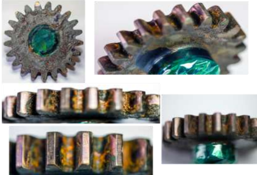
Şekil 92. Yüzeyleri TiBCN-Nb kaplanmış ve tuz sisi korozyon dayanım testine tabi tutulmuş dişliler
