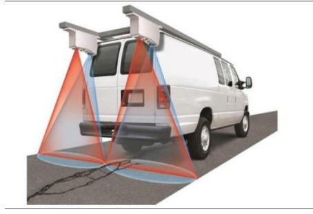
Şekil 38. Line-laser profilometre ölçüm cihazı çalışma prensibi (WARRIP, 2019)
