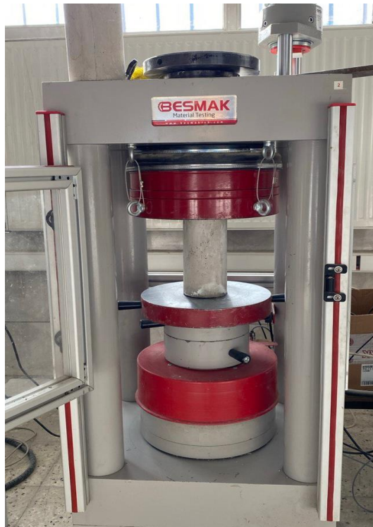
Şekil 38. Basınç dayanımı deneyi için deney düzeneği
