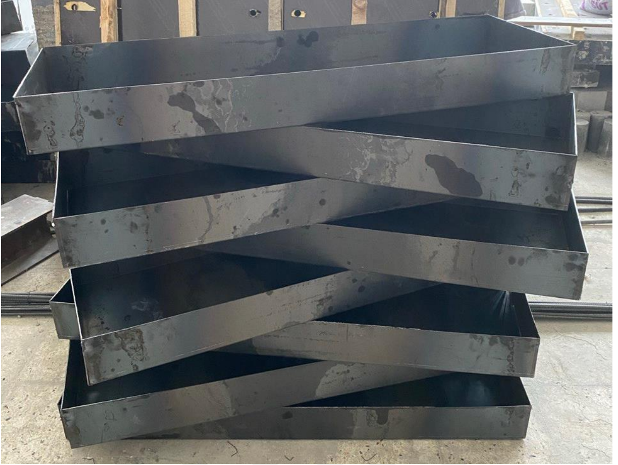
Şekil 31. Yüksek kiriş dökümü için kullanılan kalıp görseli
