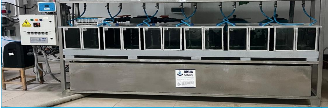
Şekil 10. Denemenin sürdürüldüğü yarı kapalı devre su sistemi.
