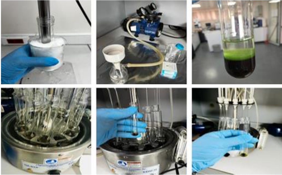
Şekil 16. Numunelerden toplam yağın elde edilme süreci
