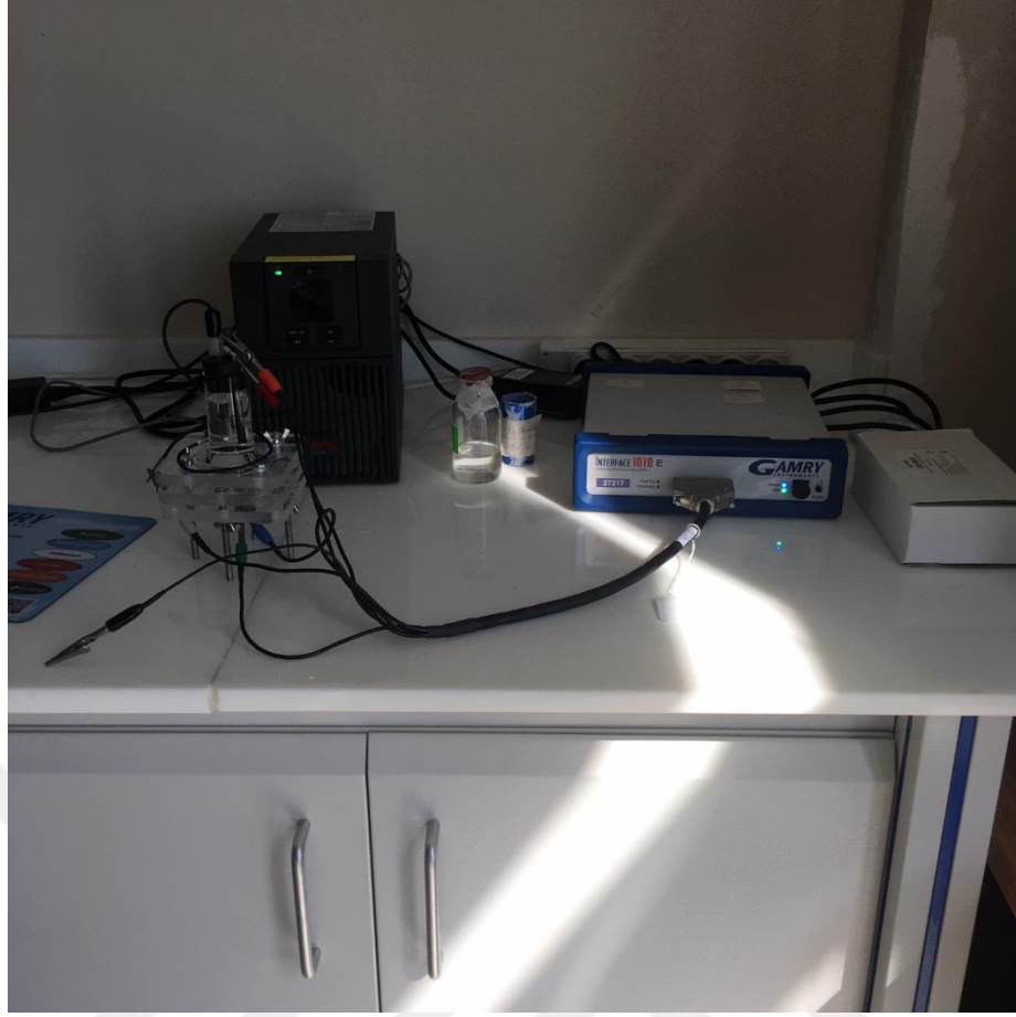
Şekil 36. Interface 1010 Potentiostat/Galvanostat/ZRA-Gamry Instruments Cihazı.
