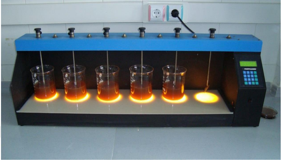
Şekil 4.3. 2 KF'nin PHIPPS&BIRD marka karıştırıcıda Fenton Oksidasyonu
