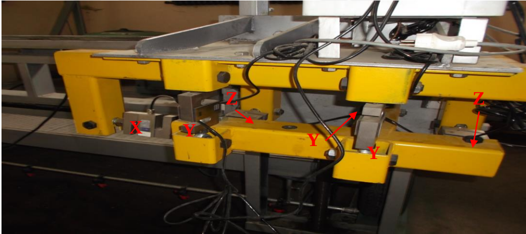
Şekil 30. X, Y ve Z Yönlerinde kuvvet ölçümü yapan ve S tipi sensörler ile donatılmış ünite
