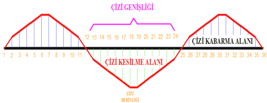
Şekil 28. Çizi kesit alanı, kabarma alanı, derinliği ve çizi genişliği
