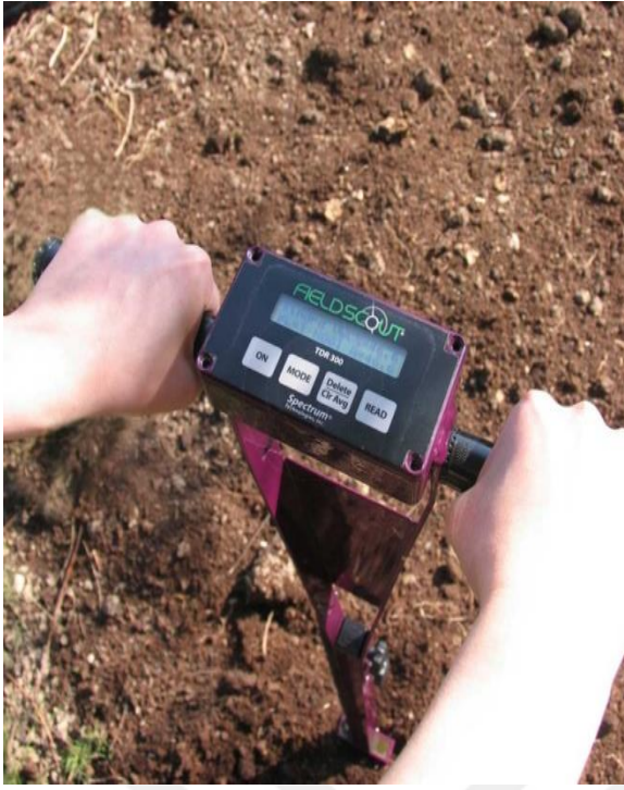
Şekil 23. TDR 300 toprak nemi ölçme cihazı
