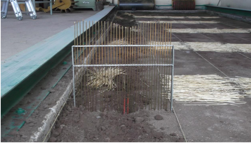
Şekil 27. Çizi profillerinin çıkarılması için kullanılan çubuklu tip profilograf
