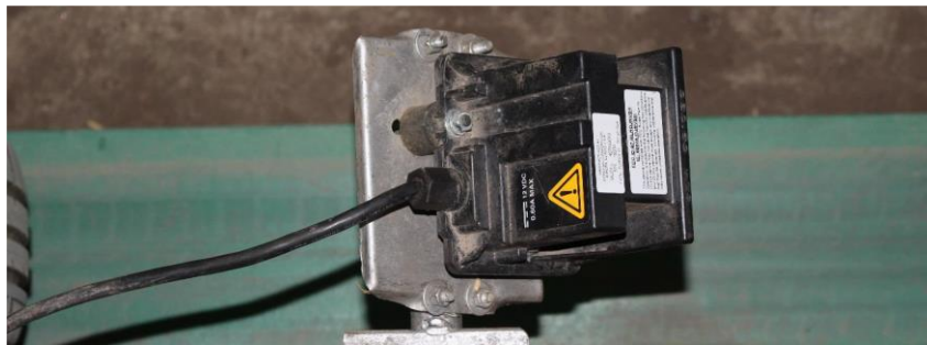
Şekil 31. Kanal arabası ilerleme hızını ölçmede kullanılan sensör
