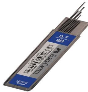
Şekil 24. Tez kapsamındaki araştırmalarda kullanılan kalem ucu elektrotlar
