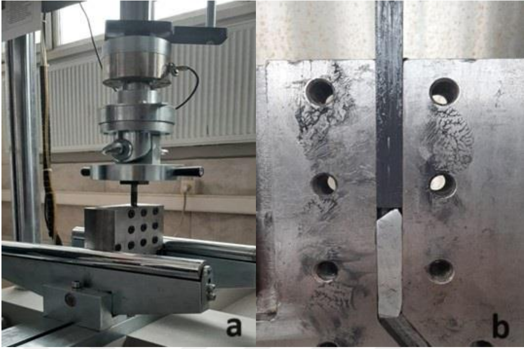
Şekil 26. Presleme işlemi (a), 2 pasoda işlem görmüş numune (b)
