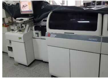
Şekil 3.8. Biyokimya otoanalizörü cihazı
