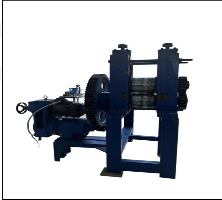
Şekil 25. Deneylerde kullanılan haddeleme cihazı.
