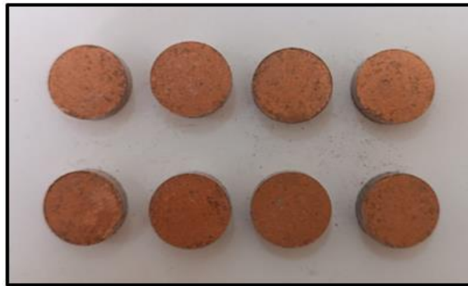
Şekil 15. Soğuk presleme ile üretilen kompozit numuneler
