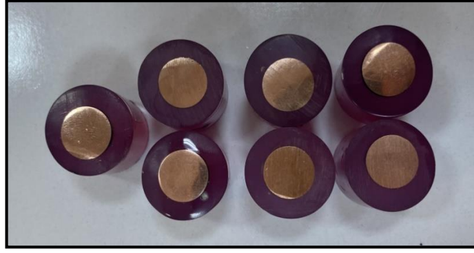
Şekil 18. Soğuk presle kompaktlanan ve bakalite alınan farklı kompozisyondaki kompozit numuneler
