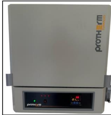
Şekil 9. Atmosfer kontrollü sinterleme fırınları
