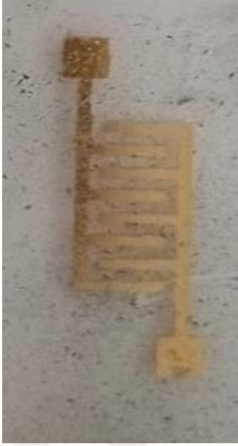
Numune A (0.3 ml PdCl 2 aşılı)
