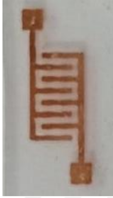
Numune B (0.5 ml PdCl 2 aşılı)
