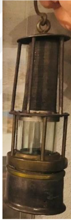
Şekil 1. Madenlerde kullanılan alev emniyet lambası (Morgan, 1936)
