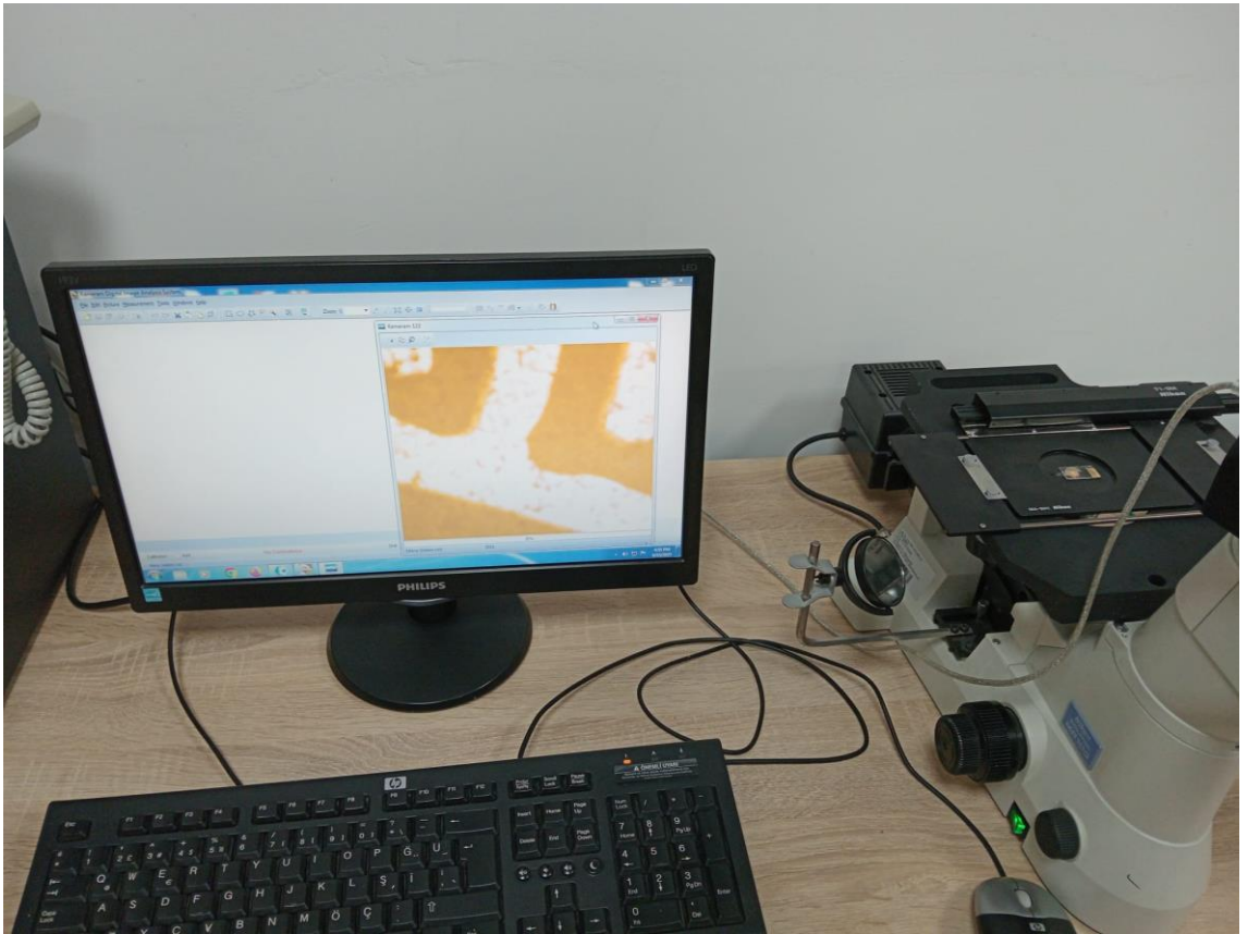
řekil 18. Laboratuvarda bulunan Nikon Eclipse MA100 marka mikroskop ile numunelere ait kontak lm grntleri
