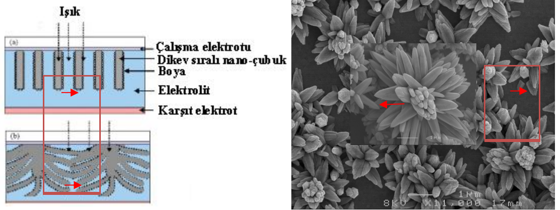
Şekil 4.43. Nano-tel (ya da nano-çubuk) ve nano-çiçeklerin yüzey morfolojisinin ışık ile etkileşiminin şematik gösterimi ve Hidrotermal metotla büyütülmüş ZnO nano-çiçekler
