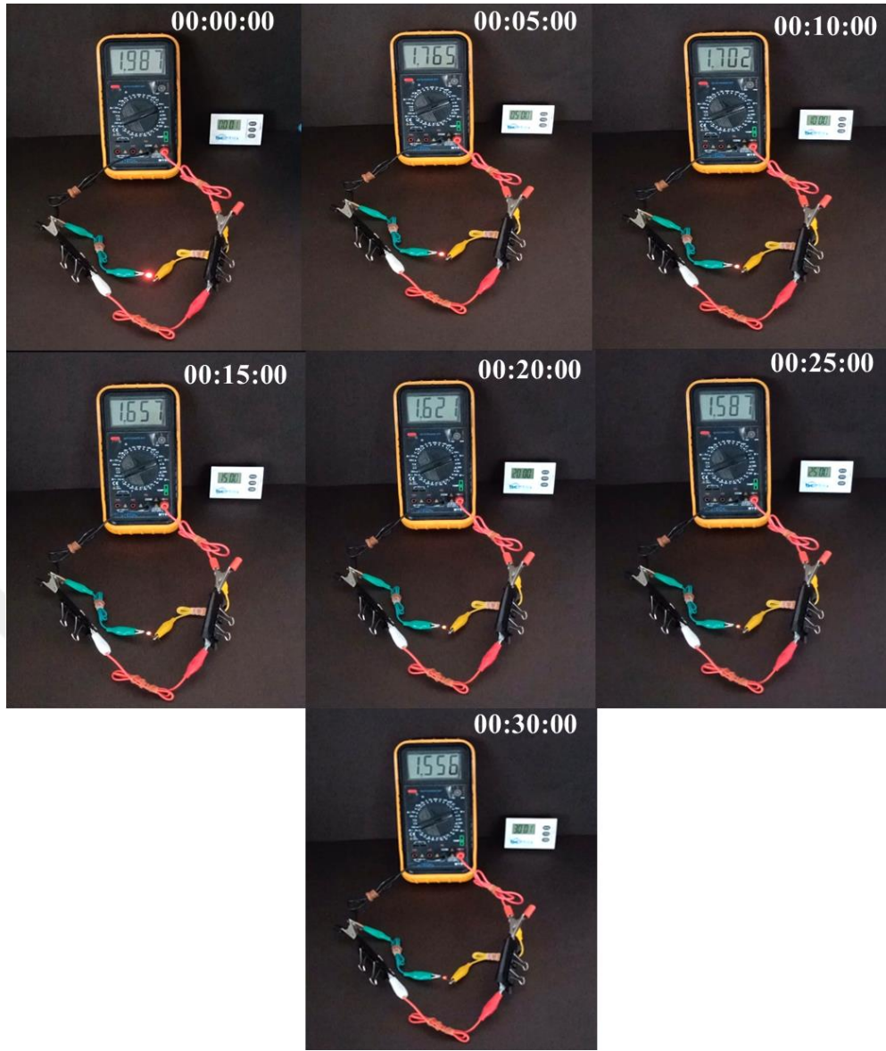
Şekil 173. DCDPS(10)-RGO:CF//RGO:CF ASC aygıtının LED lamba yakma performansı.
