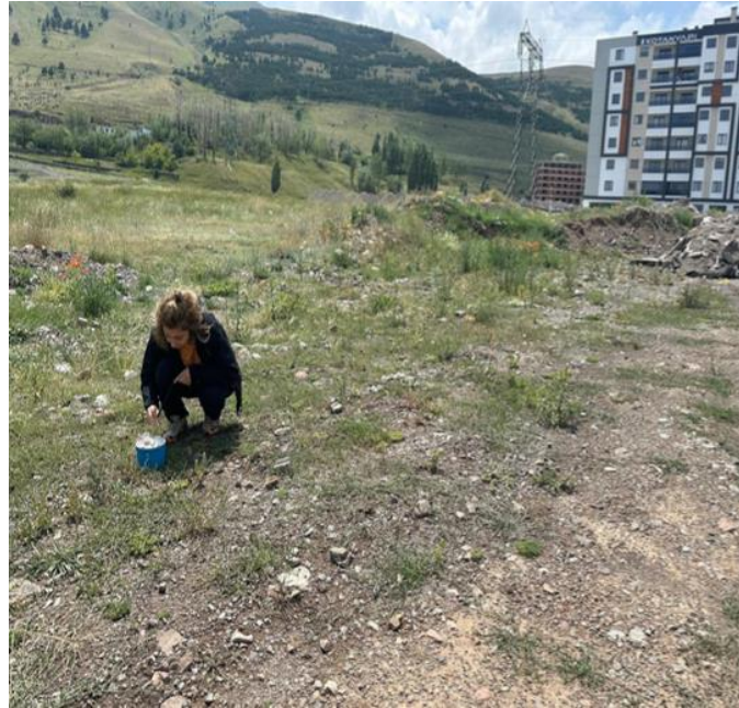
Şekil 10. Mikrotremor ölçümlerinde kullanılan sismometre
