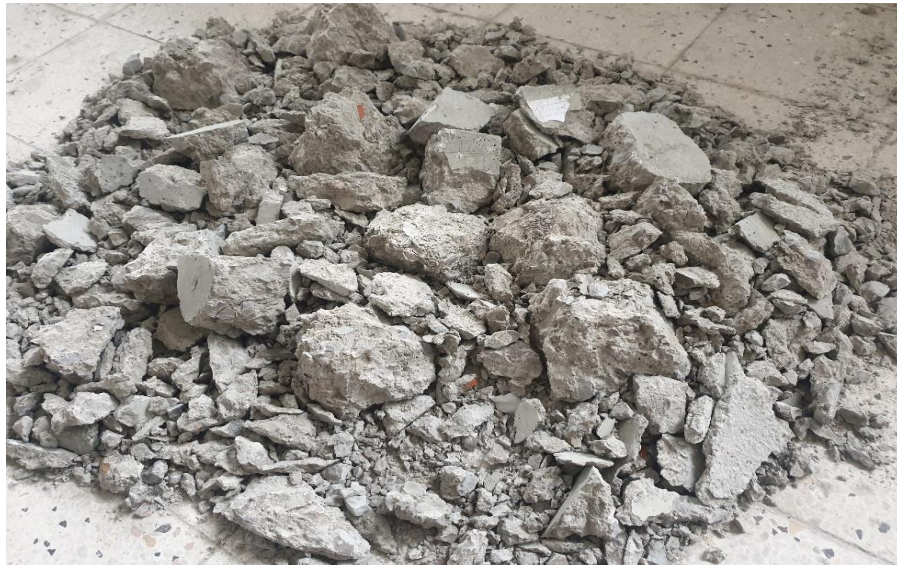
Şekil 2. Parça Haline Getirilmiş Geri Dönüşüm Agregası (4-15) mm
