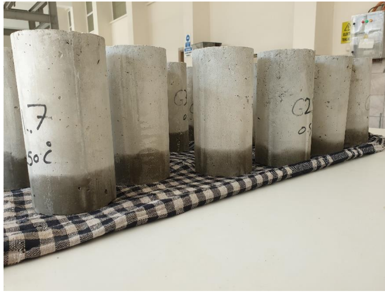
Şekil 23. Numunelerin su emme testine tabii tutulma aşaması
