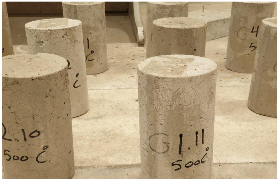
Şekil 16. Numunelerin 500^{\circ}\text{C} 'de sıcaklık altındaki etkisi
