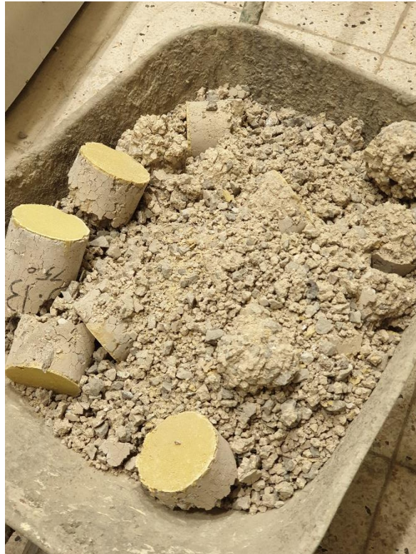
Şekil 35. 750°C’de numunelere verilen hasar derecesi
