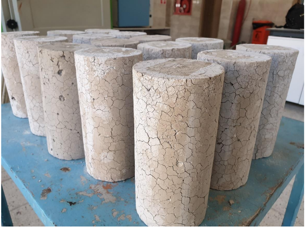
Şekil 17. Numunelerin 750°C sıcaklık altındaki etkisi
