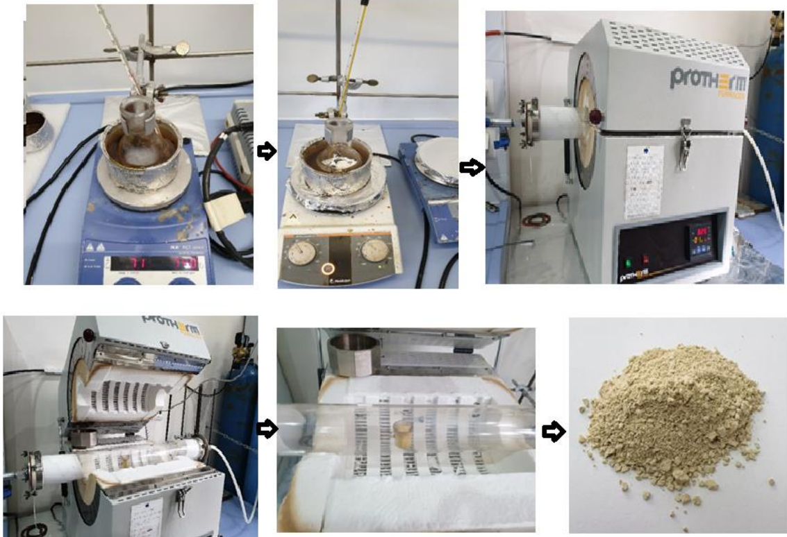
Şekil 18. mpg-CN nanokompozitinin hazırlanmasında izlenen aşamalar
