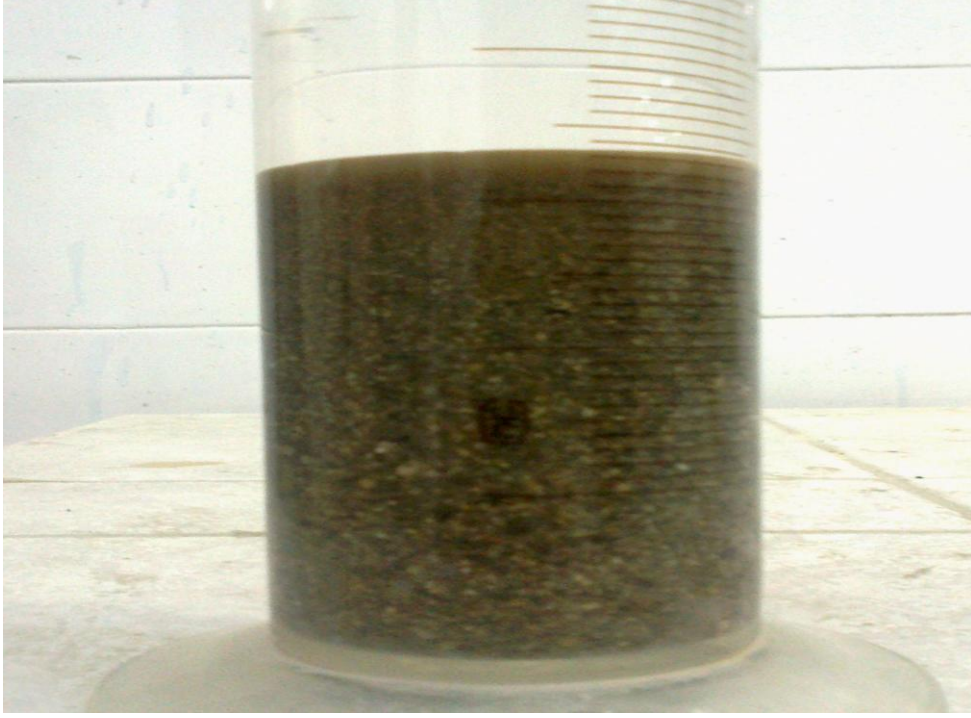
Şekil.4.3. Karışımında kullanılan agreganın bünyesinde barındırdığı ince madde
