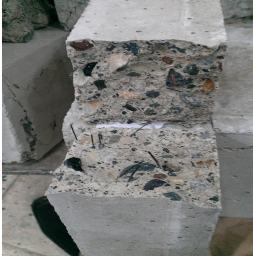
Şekil 4.6. Polipropilen lifli numunelerin eğilme yükü sonrası görünümü
