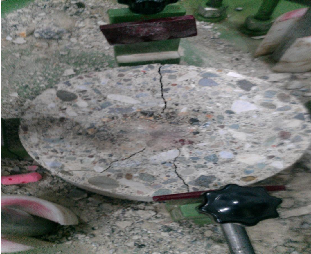
Şekil 4.10. Polipropilen lifli betonun darbe etkisi altında kırılması
