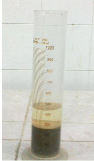
Şekil.4.2. Karışımda kullanılan agreganın bünyesinde barındırdığı organik madde
