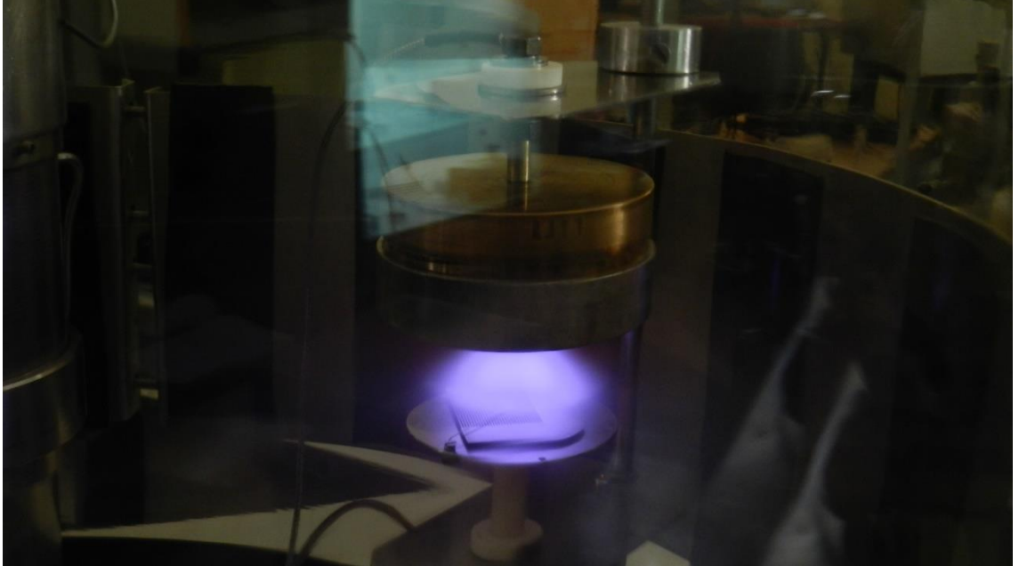
Şekil 3.11. Vakum tüpü içerisinde Au altın ince filmin 600V DC gerilim altında oluşturulan Ar plazma ile aşındırılması
