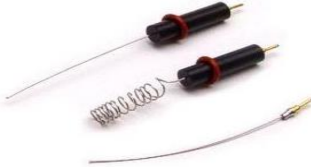
Şekil 3.3. Farklı tipte karşıt elektrotlar
