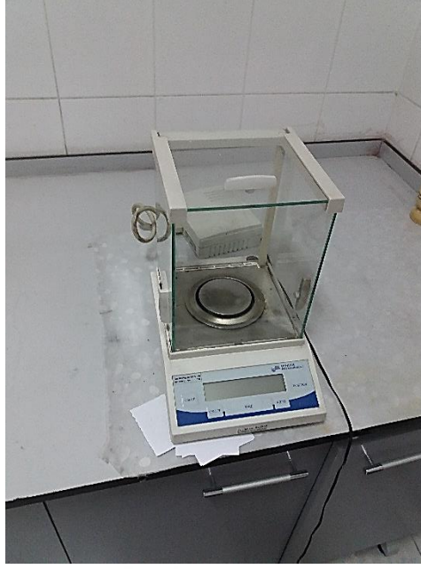
Şekil 34. Ölçümlerde kullanılan hassasiyeti yüzde binde bir olan terazi
