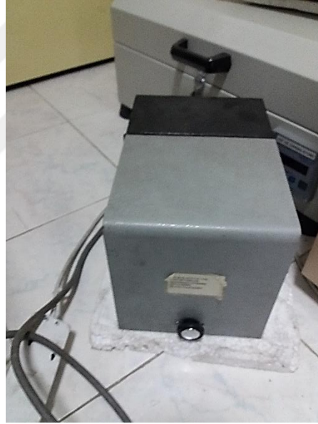
Şekil 35. Ölçümlerde alaşım oluşturulurken kullanılan çalkalayıcı
