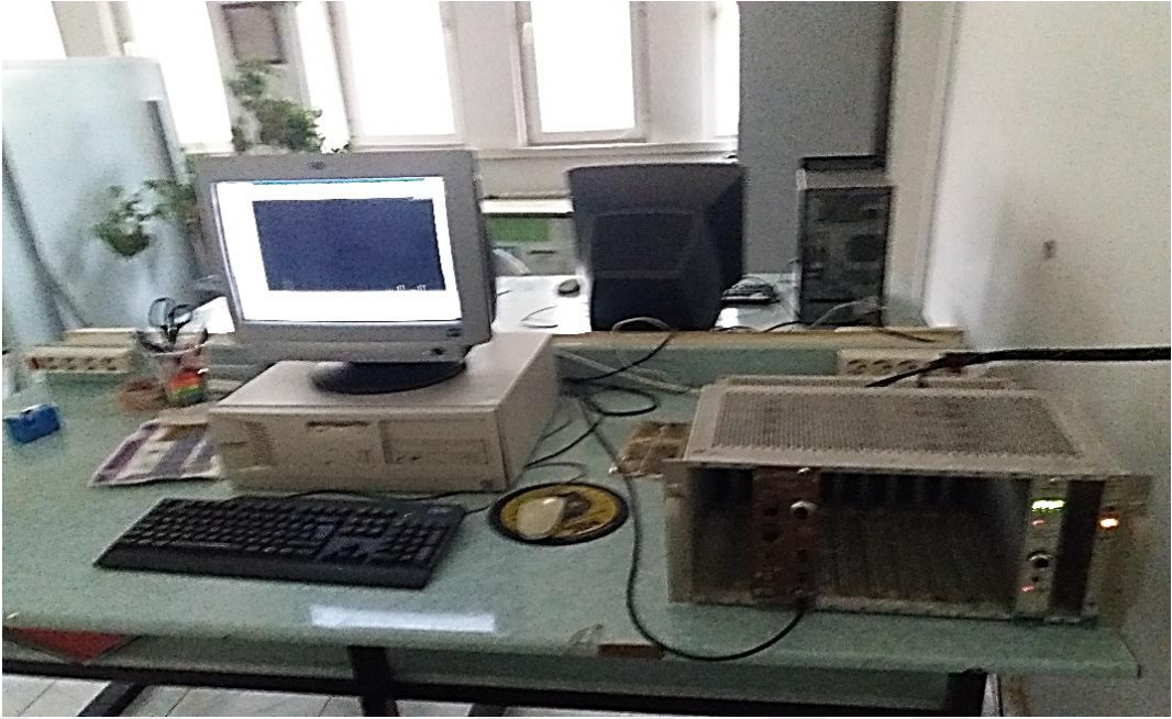
Şekil 38. Ölçüm sonucunda spektrumları elde etmek için kullanılan Genie-2000 programının yüklü olduğu bilgisayar
