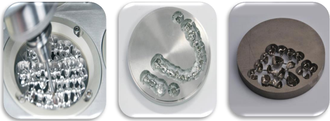
Şekil 2. 8. Frezelenmiş Cr-Co bloklar
