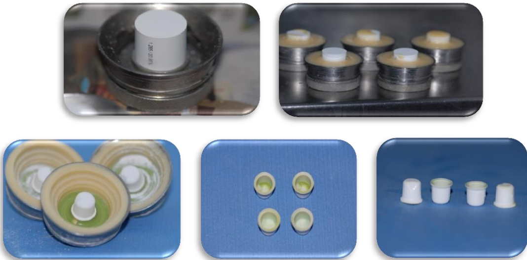
Şekil 3. 11. Kavro Everest örneklerin hazırlanması
