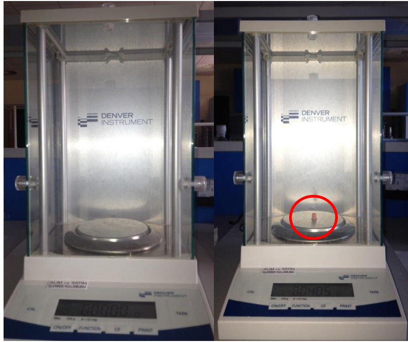
Şekil 3. 22. Hassas terazi ve silikon replikanın ağırlığının ölçümü
