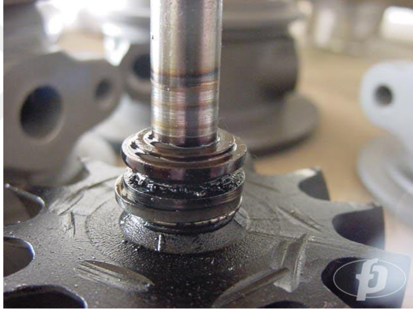
Şekil 3.52. Piston halkası bölgesinde birikmiş ve kömürleşmiş yağ kalıntıları
