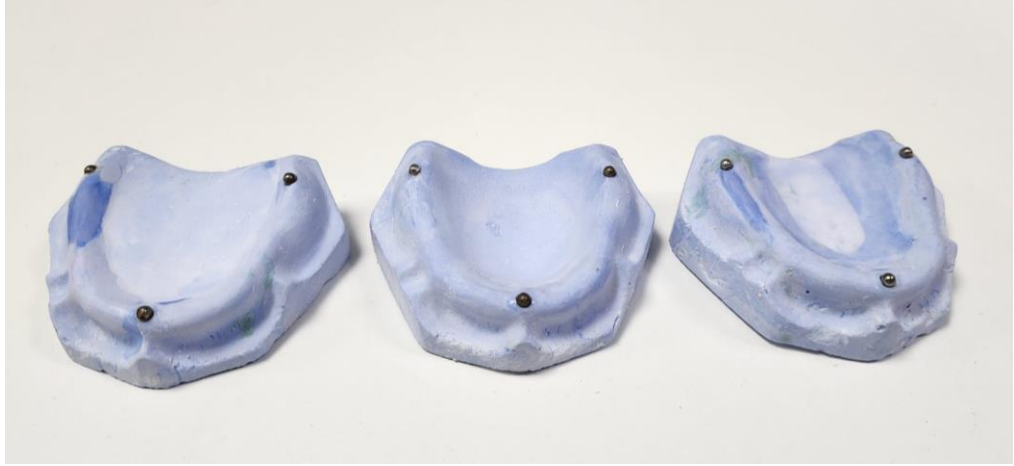
Şekil 3.4. Farklı damak derinliklerine sahip metal kürelerle modifiye edilmiş referans modeller
