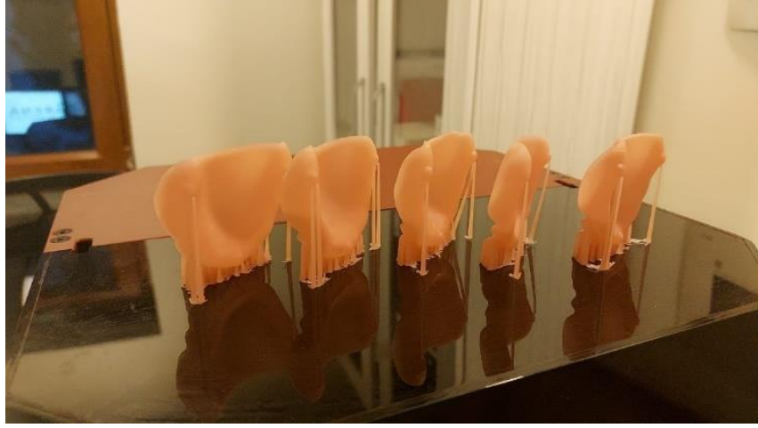
Şekil 3.10. Baskı işlemi tamamlandıktan sonra destekleriyle birlikte üretim tablasından ayrılan kaideler
