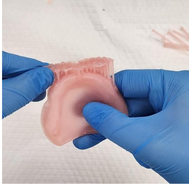
Şekil 3.11. Kaidelerin üzerindeki desteklerin en manipölasyonu ile ayrılması
